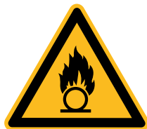
Warnung vor brandfördernden Stoffen
