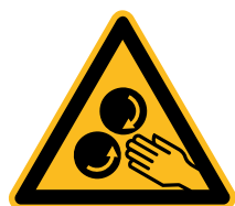
Warnung vor laufenden Walzen
